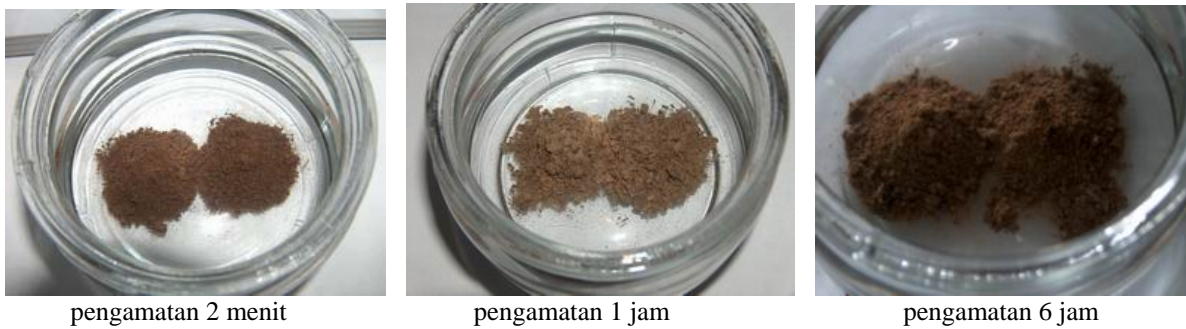
Gambar 4. Hasil uji dispersivitas bahan timbunan inti kedap air bendungan Batubulan.
