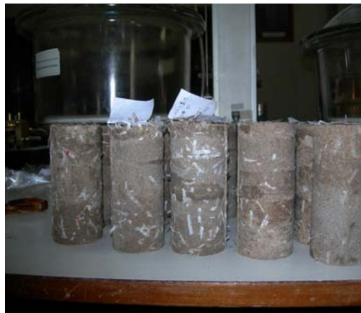
Gambar 3. Benda uji tarik belah.
