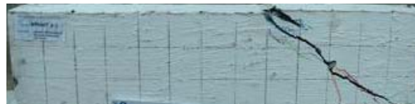
Gambar d). Balok uji dengan sengkang
