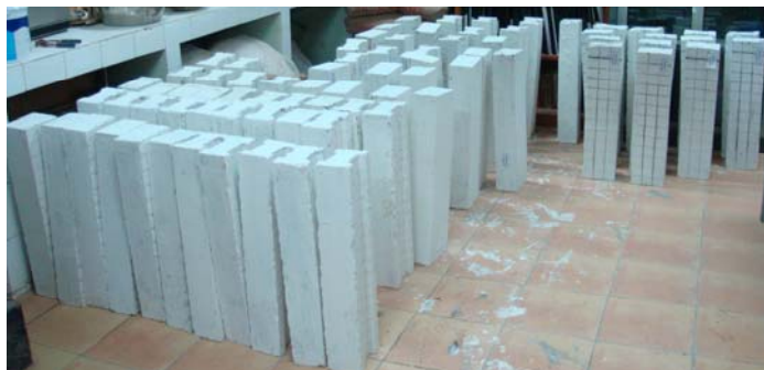
Gambar 5. benda uji berbentuk persegi dan I
