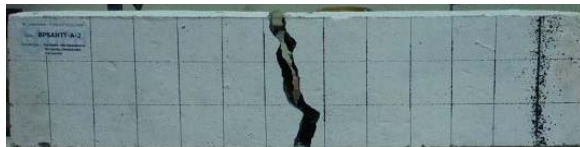
Gambar c) Balok uji tanpa sengkang
